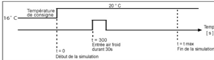
Simulation sans régulation (en boucle ouverte),
